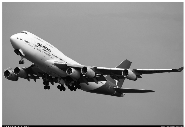
【左翼に「5個目のエンジン」を懸架したB747 （提供：Damien Aiello）】
