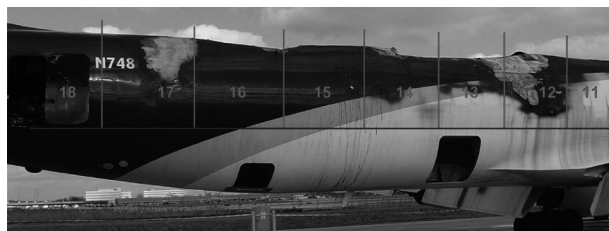
【同じくその機体外観、天井は焼け落ちている 出典：NTSB】
